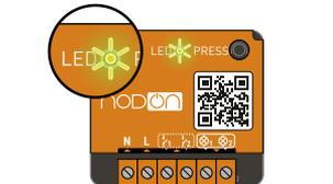
3a La LED du module scintille 2 fois en vert, confirmant l'appariage des deux appareils.
